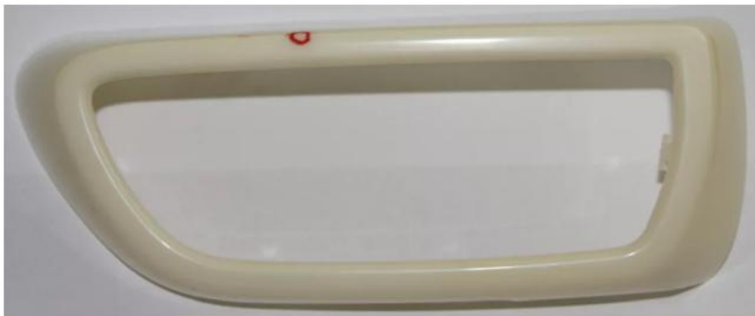
汽车排气口盖板的侧视图（红圈为缺陷处）
