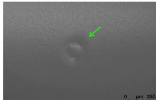
使用1/4环形光可更好反应缺陷的形貌
