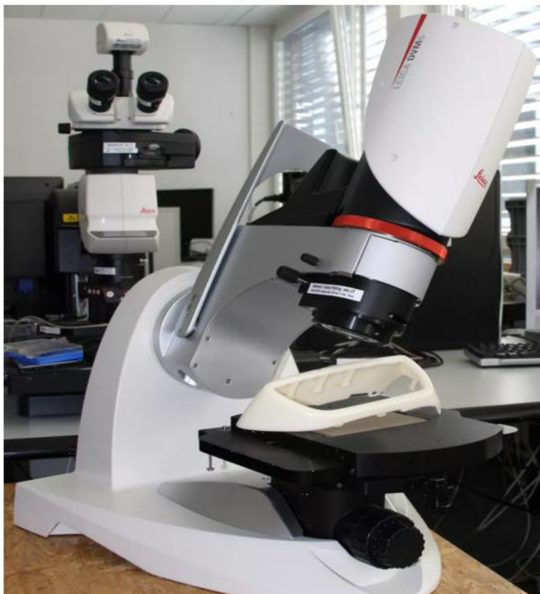
无需损坏样品，放置载物台上即可进行观察
