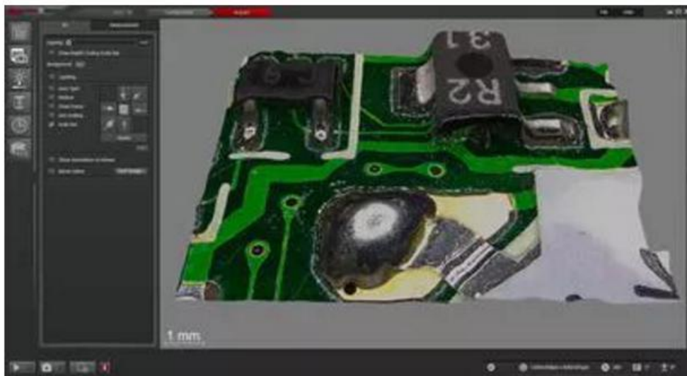
显示集成电路芯片和焊点的局部 PCB 三维图像；利用 Leica DVM6 通过 LAS X EDOF (扩展景深) 功能捕捉。亦可参见右侧带彩色 Z 标尺的相同图像。
