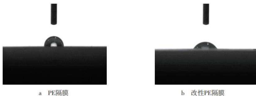
图2. 改性前后 PE 隔膜的接触角
