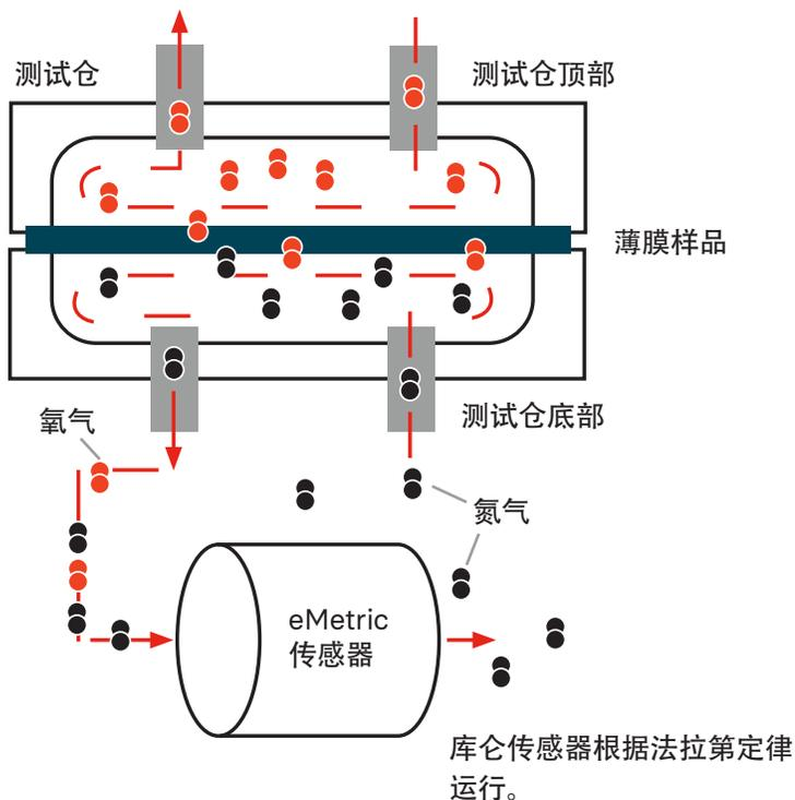
Systemch Illinois 的 eMetric 传感器可分析 100% 通过传感器的氧气，从而确保符合 ASTM D3985 标准。
